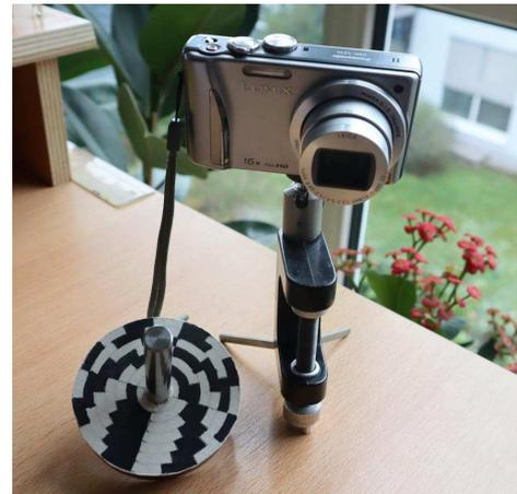
Abbildung 4: Die Stroboskopscheibe sitzt auf Kreisel Nummer 2. Zur Aufnahme leistet meine alte DMC-TZ25 von Panasonic gute Dienste.
